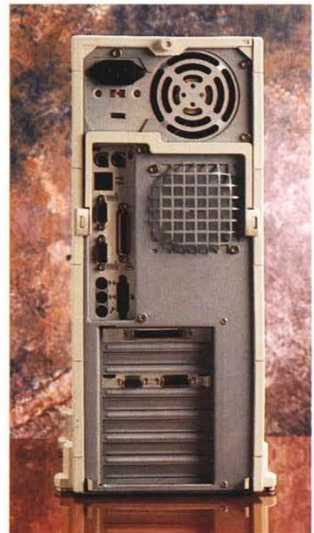
A sinistra il pannello frontale; notare i due drive per CD-ROM (quello in alto è un masterizzatore). A destra il pannello posteriore; è ben visibile il pannellino ATX.
